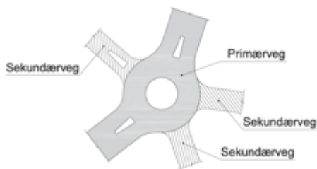
Fig. 3 Kryss i plan med rundkjøring. Skillet mellom kjørebaneer for primærveg og sekundærveg. Rundkjøringen hører til primærvegen.
